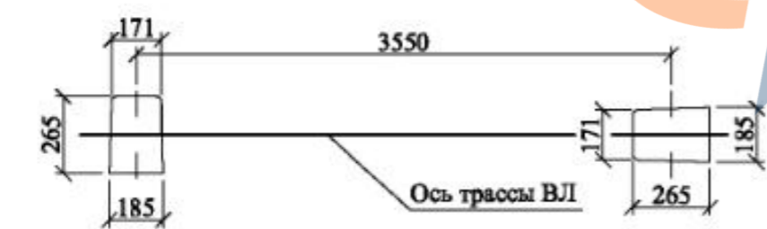
Схема установки стойки СВ95-3 (СВ95-2с, СВ95-3с)
