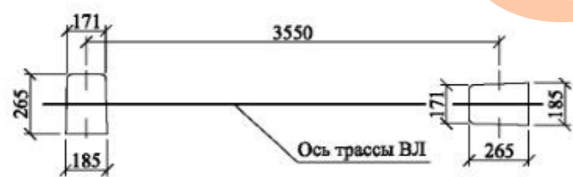
Схема установки стойки СВ95-3 (СВ95-3с)
