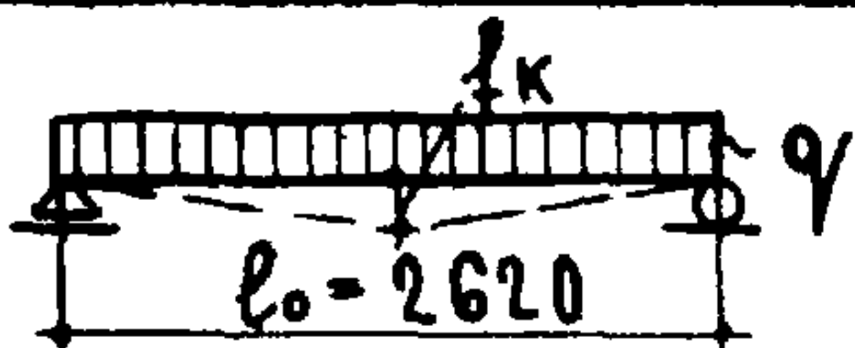
СХЕМА ОПИРАНИЯ И ЗАГРУЖЕНИЯ ПРИ ИСПЫТАНИИ (ПЛОЩАДЬ ЗАГРУЖ 2,62х1,46м)
